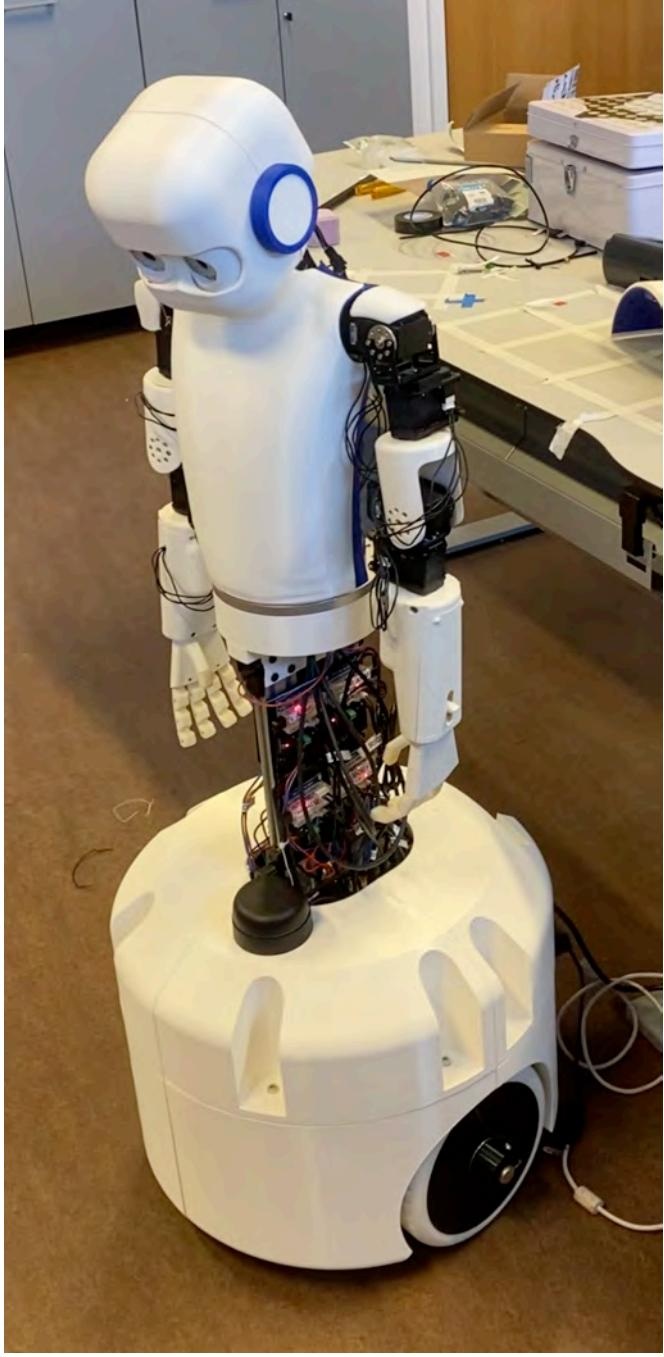
**Figur 1.** Epi med hjulbasen för differentiell styrning.
